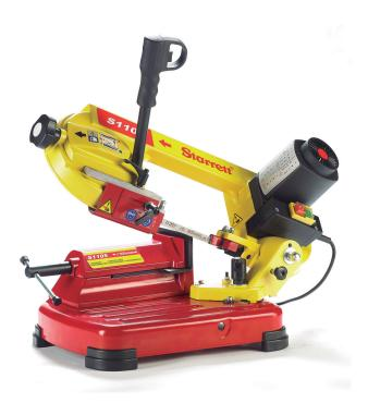
Máquina de sierra de cinta MANUAL de elevada potencia, regulación electrónica de la velocidad (2 vel.), corte angular, mordaza con guías prismáticas, tope de medición, filtro de limpieza de la sierra, muy ligera y con dispositivo de bloqueo del arco para facilitar su transporte. CORTE EN SECO
